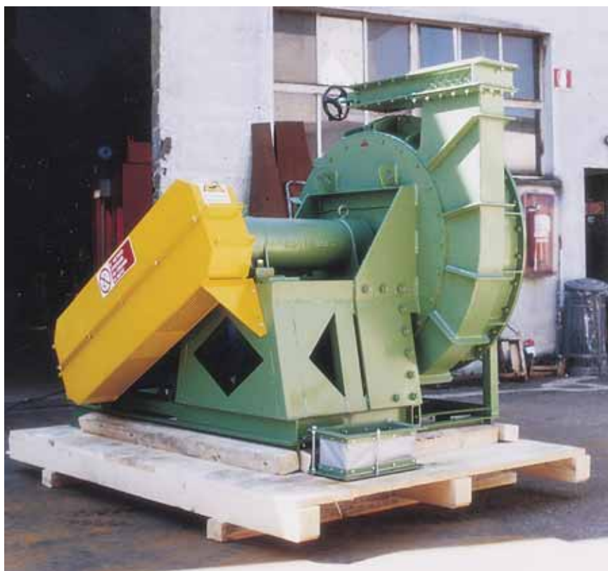
Turbocompressore bistadio portata aria 12.000 Nm 3 /h pressione 250mbar
