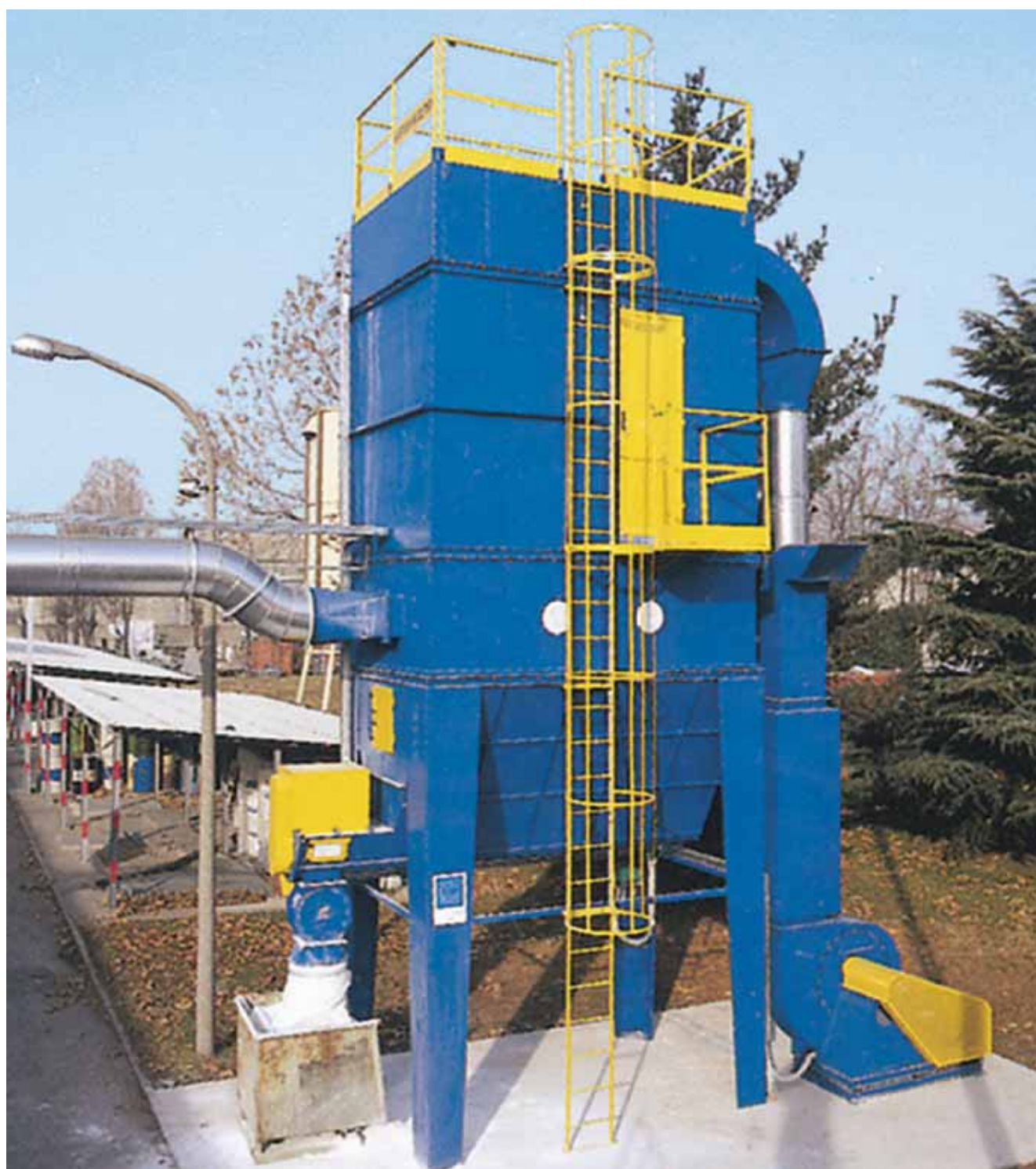
Filtro a maniche autopulente per la filtrazione di polveri di resina poliesteri. Portata d'aria 15.000 Nm 3 /h
